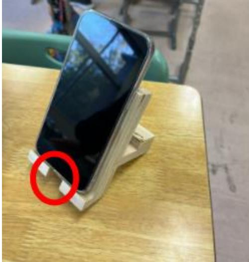
下のスマホを支える部分にスペースを空けており、充電コードを下から曲げずに差し込むことができる。また、スマホと接する面の部分が接着部分を広くするよう設計されており丈夫で、簡単には壊れないようになっている。
